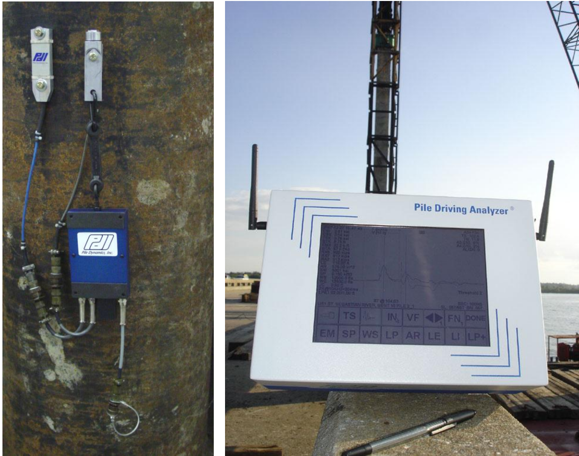
Abbildung 1: Sensoren und Sendeeinheit - Radio am Pfahl (links), Messgerät mit Empfängereinheit, Pile Driving Analyzer von PDI, Modell PAX
