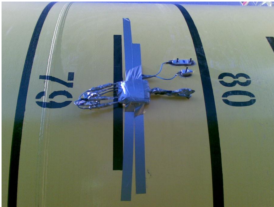
Abbildung 4: Montagezustand: kabellose Messtechnik für dynamische Probelastung
